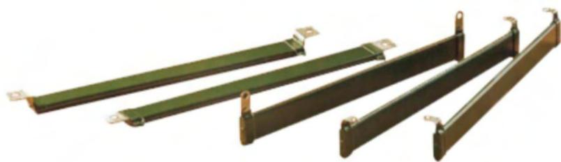
无感陶瓷抗脉冲平板电阻，单只电阻脉冲能量可达11KJ峰值电压65KV，小体积，可任意组装，高可靠性
